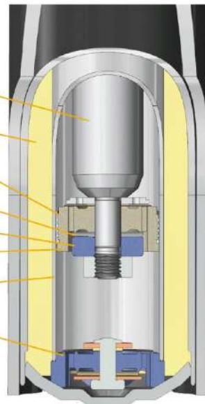
气压支柱式减振器
